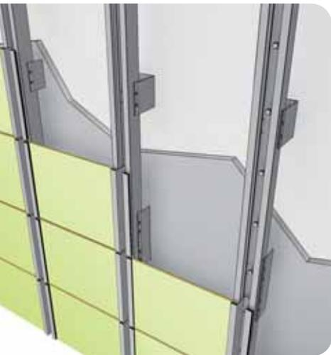
Los sistemas de perfilería vista aprovechan las amplias posibilidades formales que se puede obtener de la extrusión en el sector de la perfilería de aluminio, para configurar unos componentes que permite que las piezas cerámicas que configurarán la capa exterior de la fachada ventilada, queden atrapadas en toda su longitud vertical entre las alas de los montantes (RENDER 1.10).
